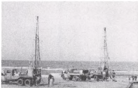
Øverst: To opriggede seismiske boretårne. Nederst: Registrering. 5 shotpoints bringes til sprængning.
