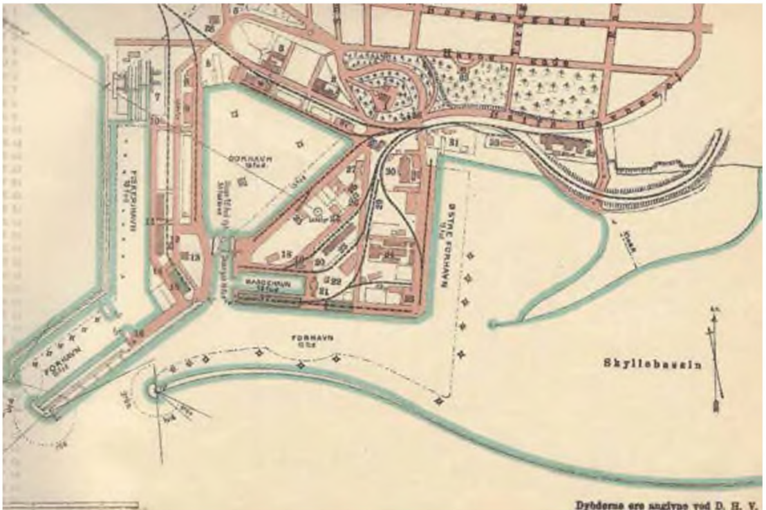
Esbjerg Havn omkring 1900. Den oprindelige havn, Dokhavnen, er udbygget, og der er etableret kaj anlæg uden for slusen. Den første fiskerihavn er blevet til bådehavn, og en ny fiskerihavn er anlagt på vestsiden af dokhavnen. Gengivet efter Alkærsig 1909, s. 144.
