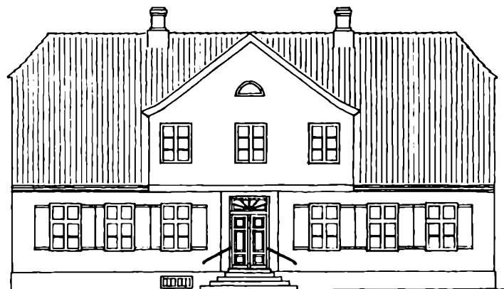
Lindegade 9 (V.kv. 18). Gavlkvisthus opført 1806 for dr. Niels Møller. Tegnet af AB på grundlag af facadeopmåling fra 1946. Mål 1:200.
