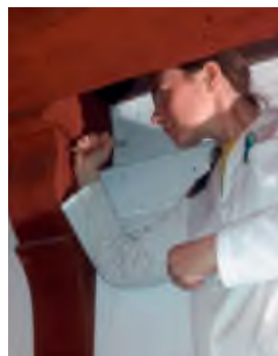
Farvekonserverator Nynne Raunsgaard Sethia udtager farveprøver fra træværket i Borgmestergården. Da farvelagene kan observeres i tværsnittet gennem et mikroskop, behøver prøven ikke være stor. En udtagning med kanyle er tilstrækkeligt.
