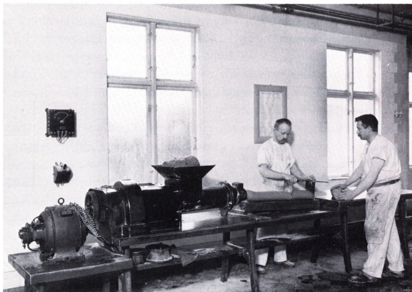
Rugbrødene skæres ud. Billedet er fra Arbejdernes Aktiebageri i Vindegade 1911, og maskinen drives af en Thrigmotor (Otto Normark fot., privateje).
