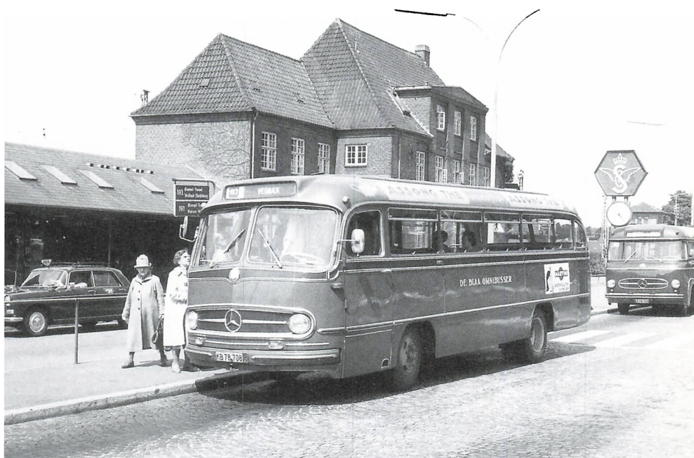
En Mercedes 1962 foran Holte Station i begyndelsen af 1960'erne. Den var bygget på de tyske busfabrikker i Mannheim. Bussen var indrettet til eenmandsbetjening med indstigning foran. Som noget nyt var motoren anbragt bagest i bussen. (Foto: John Kåre Bjørnson)
