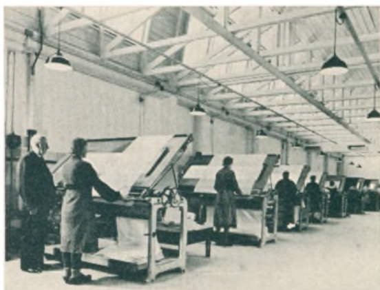
Fra Maaleriet, hvor alle Varer ved Gennemlysning grundig efterkontrolleres for eventuelle fejl
