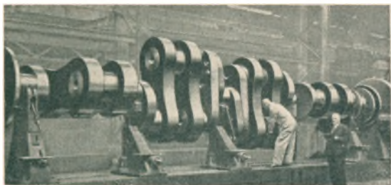
Kompliceret Krumtapaksel (Doxford Type, Længde 10 m, Vægt 42 Tons) Ruhrstahl A.G., Henrichshütte
