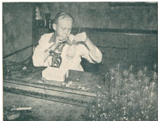
Paasmeltning af »Siderør« paa Flasker
