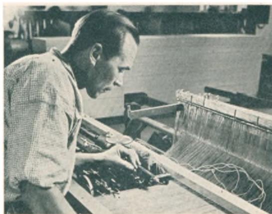
En moderne Knyttmaskine, der nu ad mekanisk vej udfører det Arbejde, der før blev foretaget med Haanden
