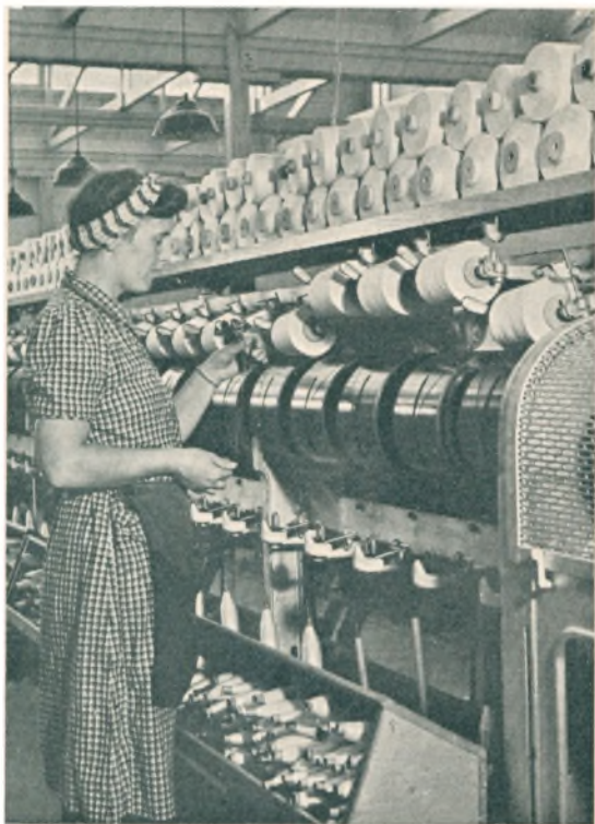
Fra Garnnøgleriet, hvor Garnet oplægges paa coniske Krydsnøgler
