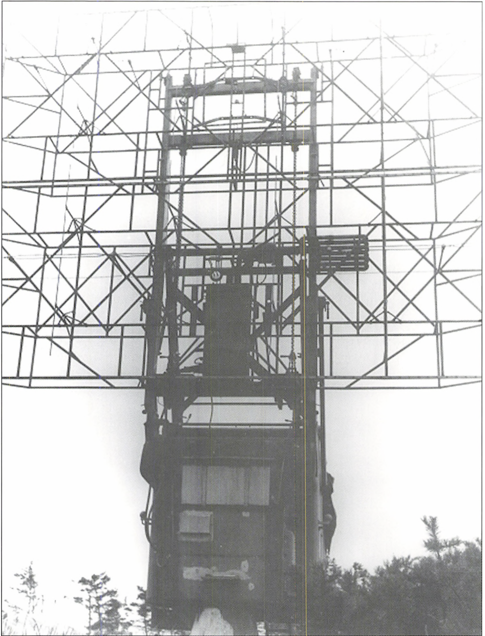
Reflektoren med dipoler på FuMO 303. Antennen var todelt. Den nederste halvdel fungerede som sender og den øverste som modtager. (Nr. 1 på tegningen side 112). (Gilleleje Lokalhistorisk arkiv).
