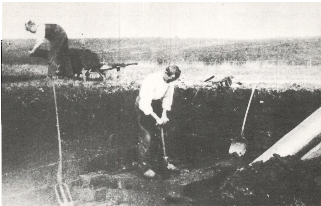
Tørvegravning ca. 1930. Tørvene stikkes ud med spade og lægges derefter op på kanten med tørveskovl (til venstre). Røret (til højre) er en vandsnegl - en effektiv indretning hvorved man løftede vandet op af tørvegraven. (S.A.)
