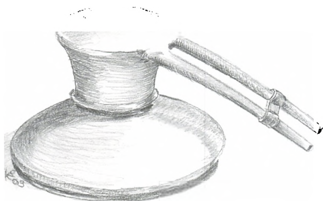
Brændevinshat af kobber. Hatten blev sat over kedlen så dampen kunne stige op og trænge ud gennem svalerorene.
