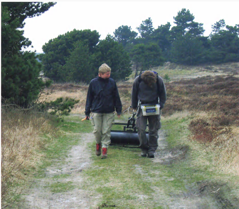
Billede 2. Georadaren trækkes hen over jordoverfladen på Rømø.
