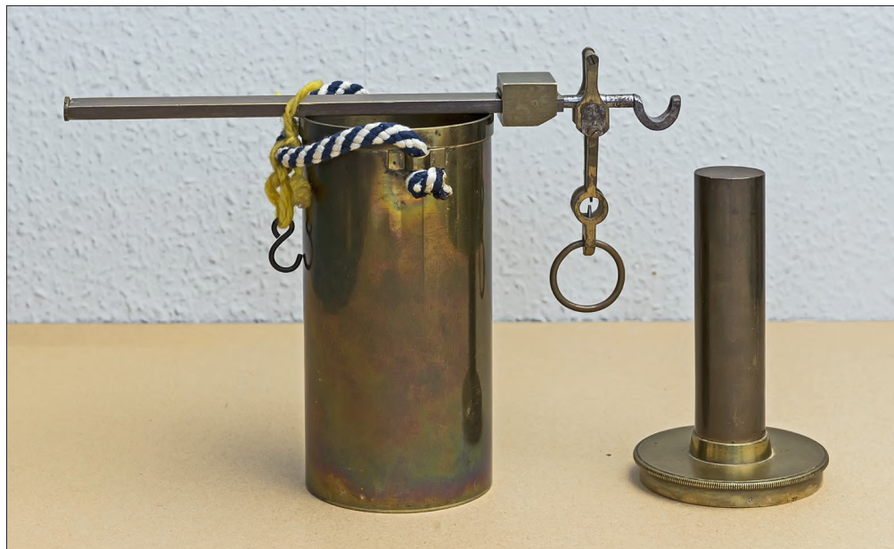
En hollandsk vægt til beregning af korns kvalitet. Cylinderen fyldes helt op med korn og stryges af med skافتet. Derefter vejes den. Jo højere vægt i "pund hollandsk" jo højere kvalitet har kornet. Foto: Lokalarkivet.
