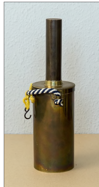
En hollandsk vægt til beregning af korns kvalitet. Cylinderen fyldes helt op med korn og stryges af med skافتet. Derefter vejes den. Jo højere vægt i "pund hollandsk" jo højere kvalitet har kornet. Foto: Lokalarkivet.
