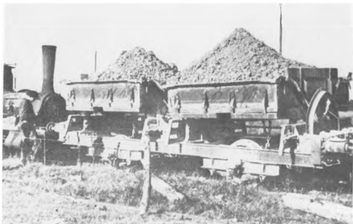
Fig. 9. Den normalsporede tipvogn med sine to tippelad. Ved aflæsning blev vognsiderne først slået ned i vandret stilling. Vognen blev mest benyttet lokalt mellem Klåbygård og Hviding st, og viste sig også at være velegnet ved læsning af lastbiler. (efter H. Skodshøj, 1947).
