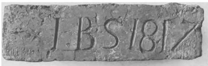
Fig. 12. Mursten fra gården matr. 12, Janderup. Rød, jævnt godt brændt, ret regelmæssig form. 25,5 cm lang, 12 cm bred og 7 cm høj. Inskription kun på én af de lange smalflader, der er glattet her, angiveligt for at give et godt grundlag for inskriptionen, der tydeligvis er skåret ind med en kniv og smukt udført. Teksten er: IBS 1817. Initialerne IBS står for Jørgen Bennedsen (1780-1858), der ejede denne gård. Stenen er i forfatterens besiddelse. Foto af forfatteren.
