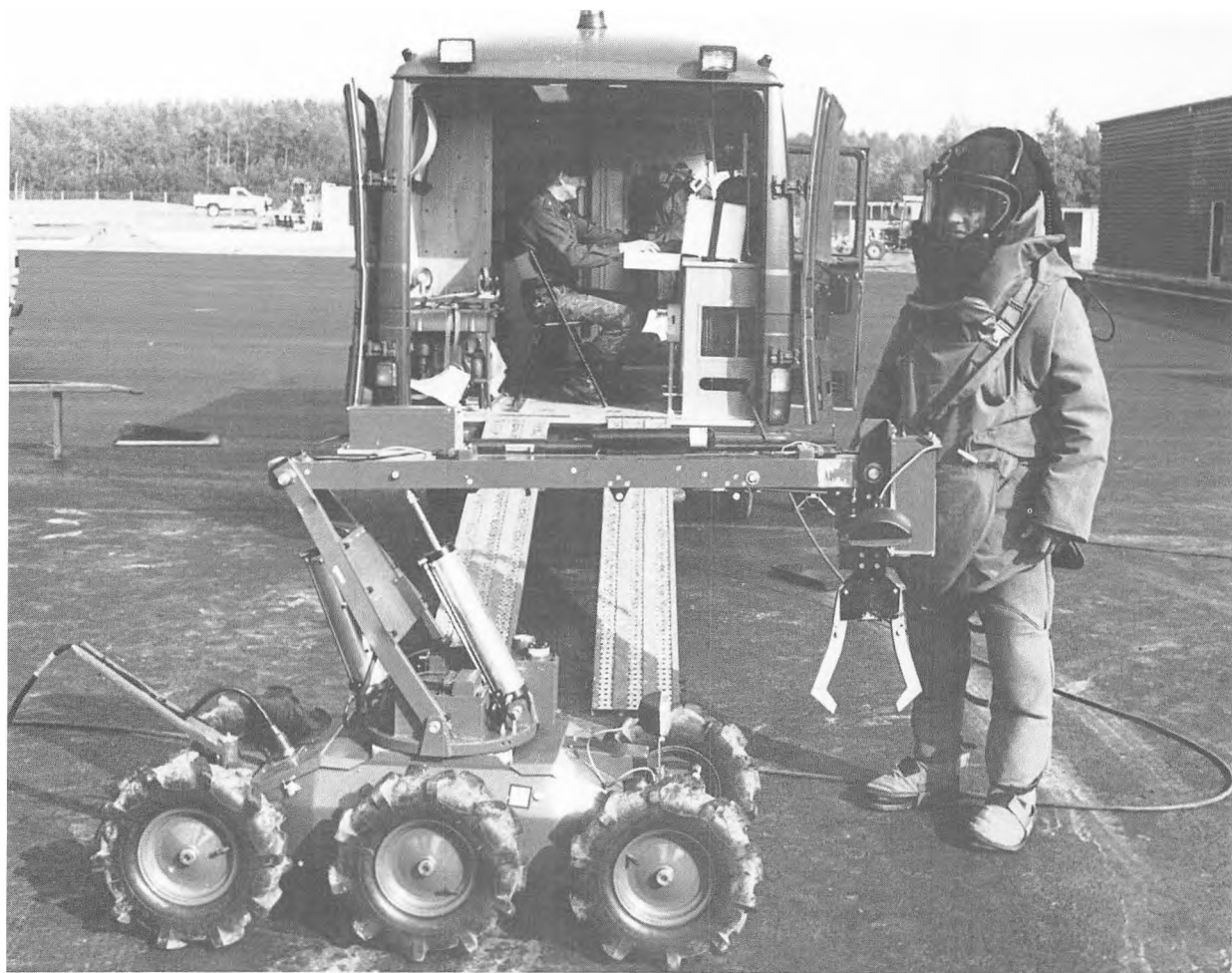
Til undersøgelse og uskadeliggørelse af bomber m.v. anvender hærens ingeniørtropper en fjernstyret robot. Den hidtil anvendte type "Rullemarie" blev i 1985 udskiftet med den mere moderne HOBO, der ses her. Foto: Politiken
