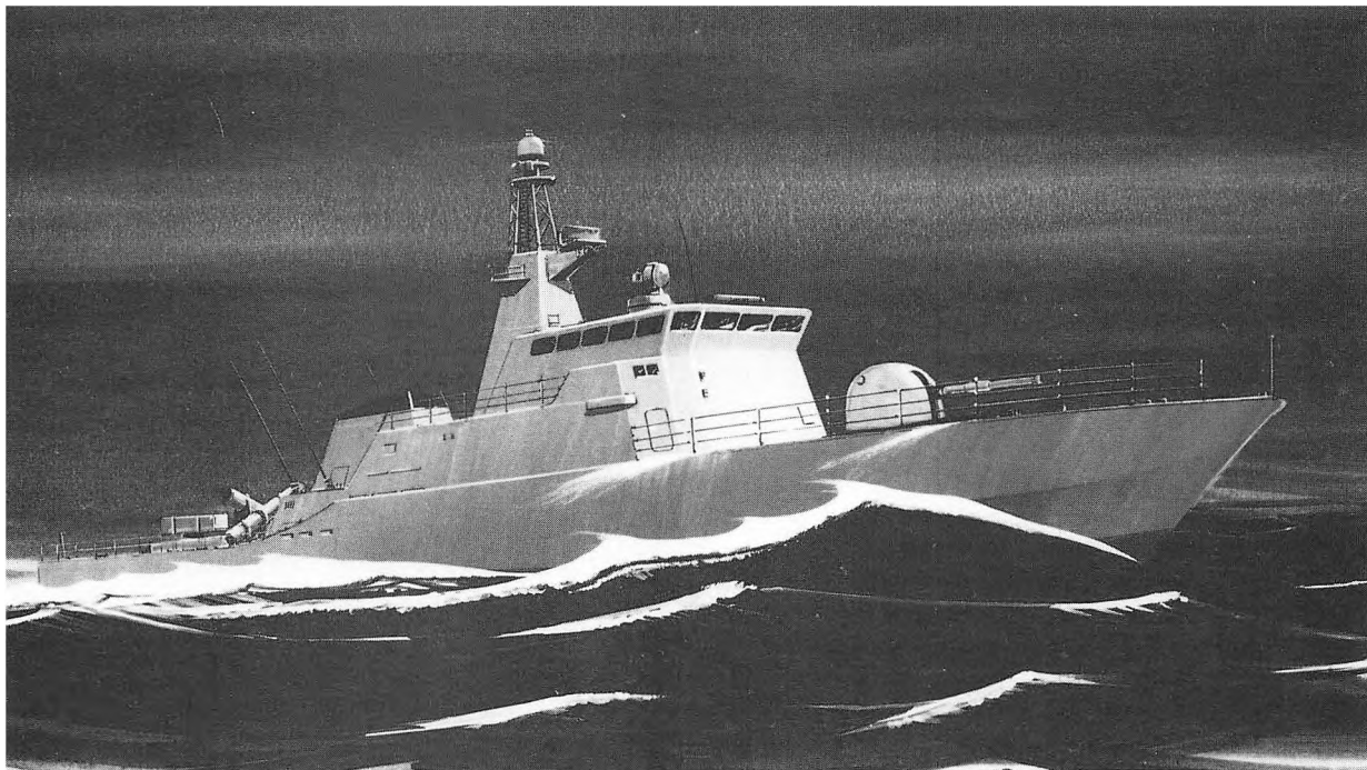
Til erstatning for søværnets ældre bevogtningsfartøjer og minestrygere anskaffes foreløbig 7 skibe af typen STANDARD FLEX 300. Skibene bygges i glasfiberarmeret polyester. Tegning: Søværnet
