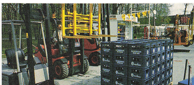
Et af de mange eksempler på 2-pallets gaffeltruck.
