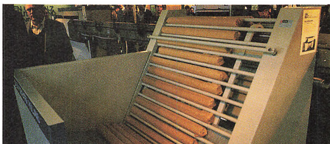
Automatisk lågfødeanlæg til dåsekolonne, system CSW Thomassen og Drijver-Verblifa.
