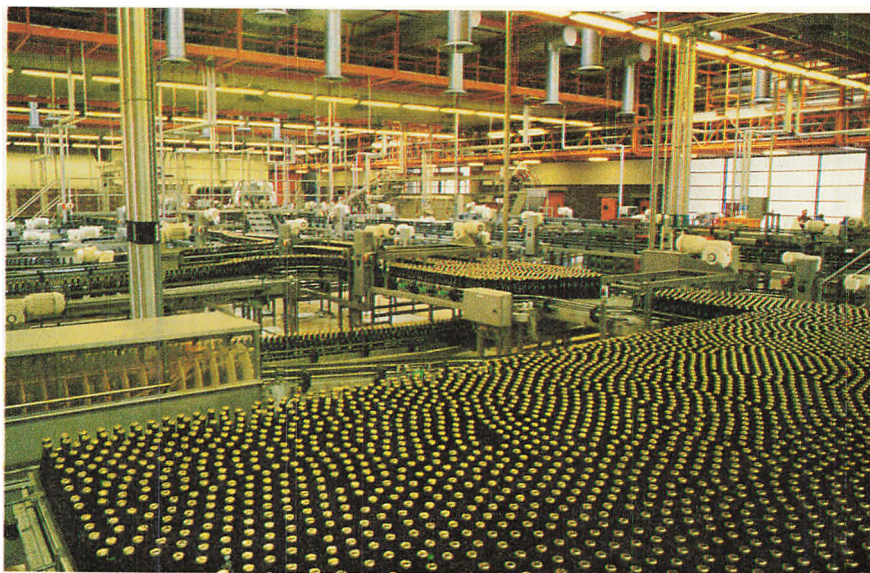
Flaskeakkumuleringsbord efter pasteuriseringsapparatet
