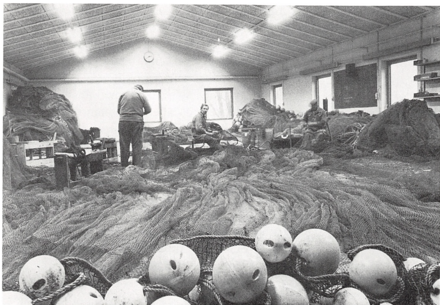
Flyderad under reparation hos H. W. Larsen og Sønner i Klintholm. De uundværlige »heste« er både arbejdsstol og værktøjskasse. Foto: P. H. Moustgaard.
