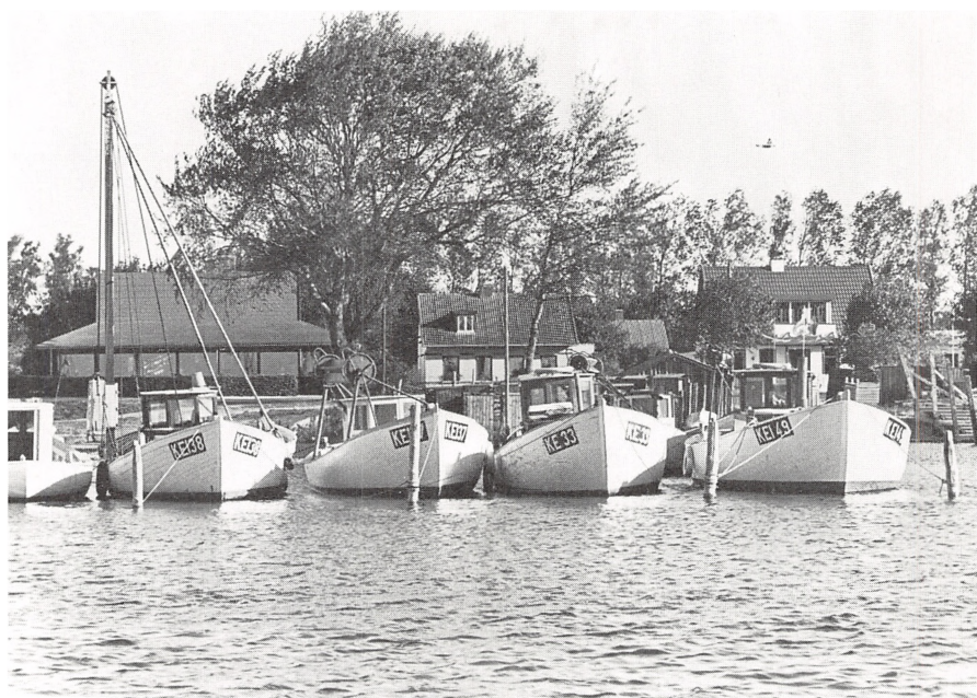
Joller tilhørende P. Larsen og P. E. Hansens bundgarnsfirma i Klintholm Havn. På KE 138 er der monteret ramslag til pæle og på KE 137 en hydraulisk vinde til udsætning og optagning af garnene. Foto: P. H. Moustgaard.
