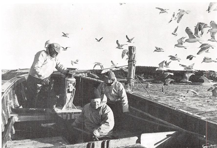
Jolle fra Grenaa-Ebeltoft Bundgarnsselskab. De hydrauliske spilkooper har lettet det tunge arbejde med at hive netbund og ruser op under røgtning. Foto: T. Vestergaard, Dansk Fiskerimuseum.
