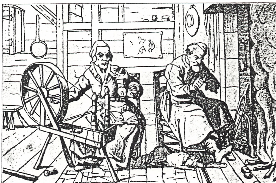
Spinderok med Hjul, der drejes med Haanden. (Efter Joh de Brunes. Amsterdam 1636.)
