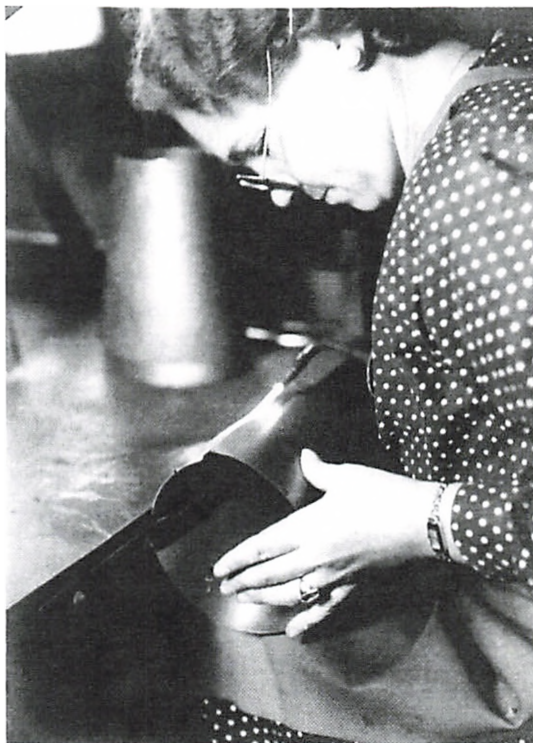
Kvindelig blikkenslager i færd med at lodde kroppen på en kaffekande.
