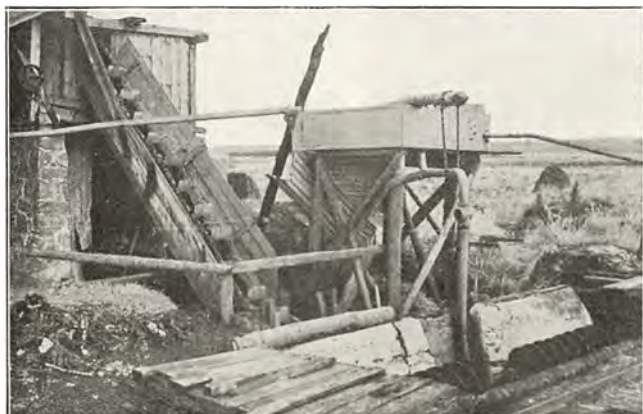
Et lille Tørveværk til Æltning af den opgravede Tørvemasse. (R. H. Stamm fot.)
