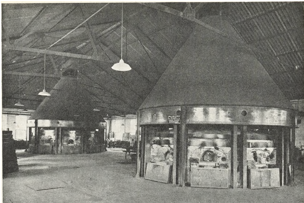
To af Teisens Glasovne, installeret i Stuart & Sons berømte Krystalværk i Stourbridge
