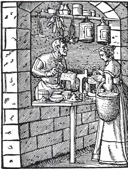
Joost Ammans træsnit fra 1500-tallets midte viser en lygtemager i sit værksted. Han smeder et lygtehus over sin ambolt. Den versificerede tekst fortæller, at han leverer lygter til alle formål – kirkelige, militære osv.
