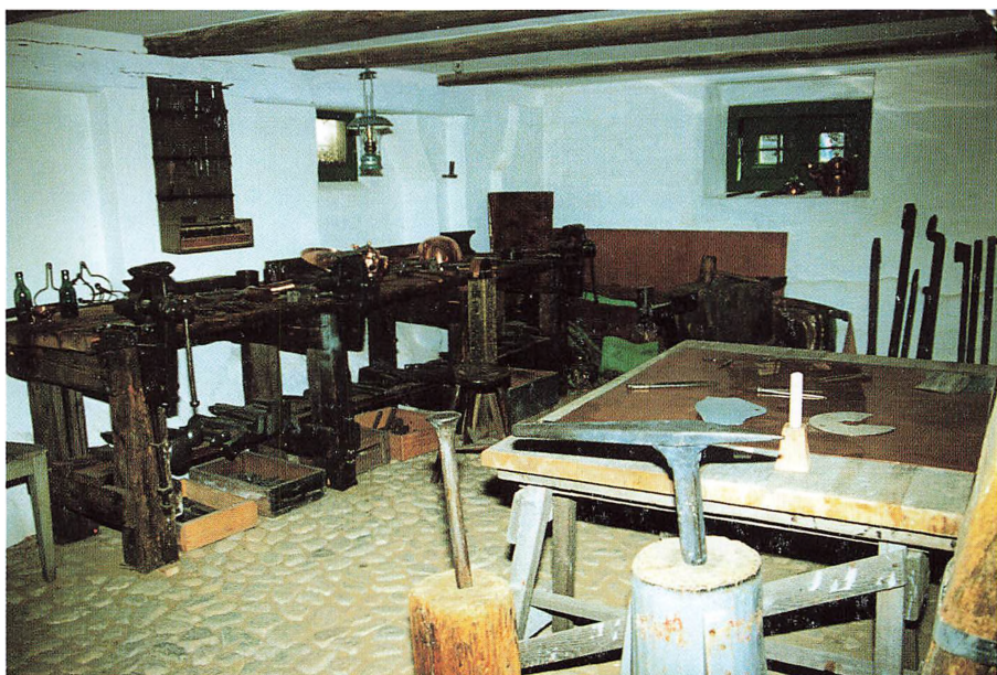
Det nyindrettede kobbbersmedeværksted i Svendborghusets lavloftede kælder. Langs væggen til venstre ses arbejdsbænken med forskelligt værktøj. Under bænken ligger der ambolte, og der står kasser med småt værktøj. Langs endevæggen ser vi kobbbersmedens råmaterialer og hans store liggeambolte. En liggeambolt er kilet fast i en arbejdsklods. I forgrunden to arbejdsklodser med ambolte, samt et bord med skabeloner og passere til opmåling. Elsebeth H. Mikkelsen. fot.
