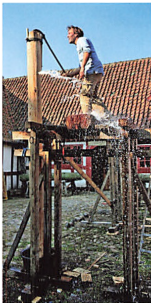
Under dette års håndværksweek-end lykkedes det at få en rekonstruktion af en trøpumpe, fremstillet efter gamle teknikker, til at virke. Foto Mathilde Bech.
