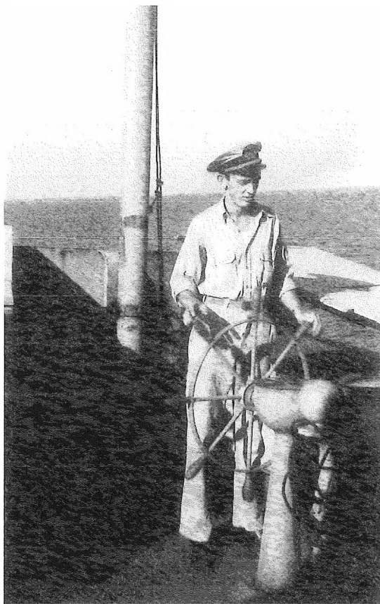
2. styrmand Lyse afprøver skibets nødstyring, der har rattet placeret på dækshuset agterude. (Forfatterens foto)
