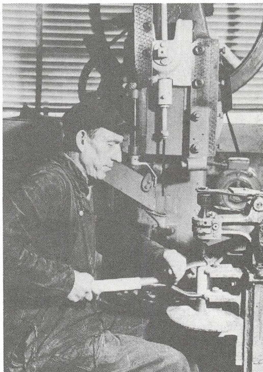
Håndtak klinkes på en spade i redskapsfabrikken. Foto: Chra. Spigerverk.
