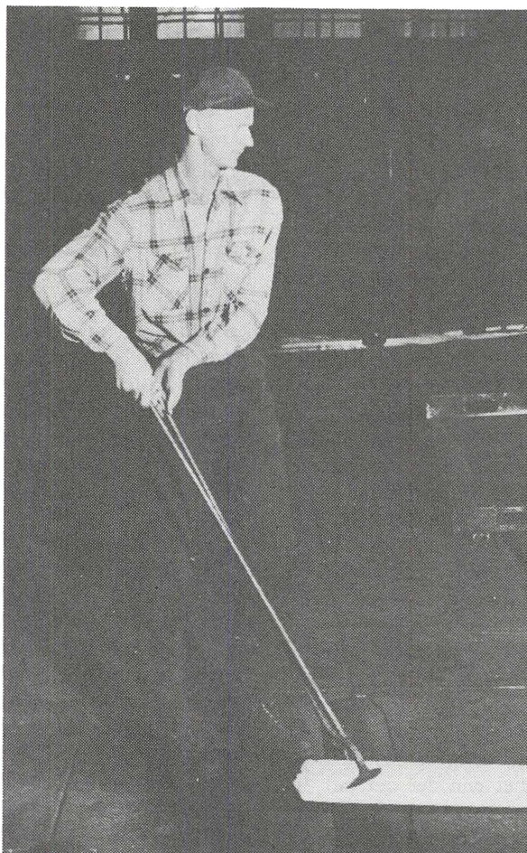
Fra finvalseverket på Christiania Spigerverk ca. 1955. Valserven griper tak i det glødende emnet med tangen, og manøvrerer det inn i neste valsepar. Foto: Chra. Spigerverk.
