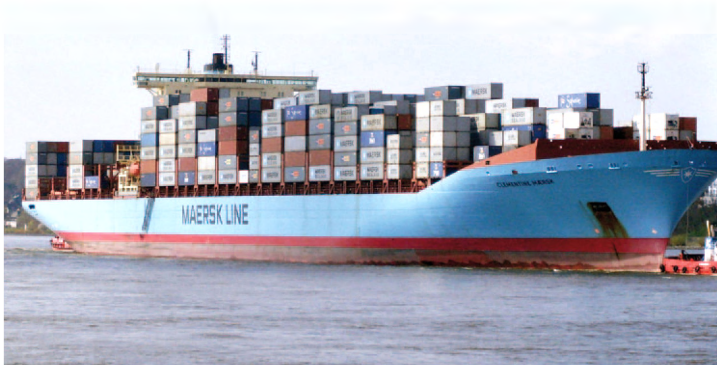
M/S CLEMENTINE MÆRSK, bygget i 2002 på Odense Staalskibsværft A/S, Lindø. Skibet er 347 meter langt og kan medføre mere end 8.000 stykker 20-fods containere. (Foto Horst Rahmelow, Hamburg)
