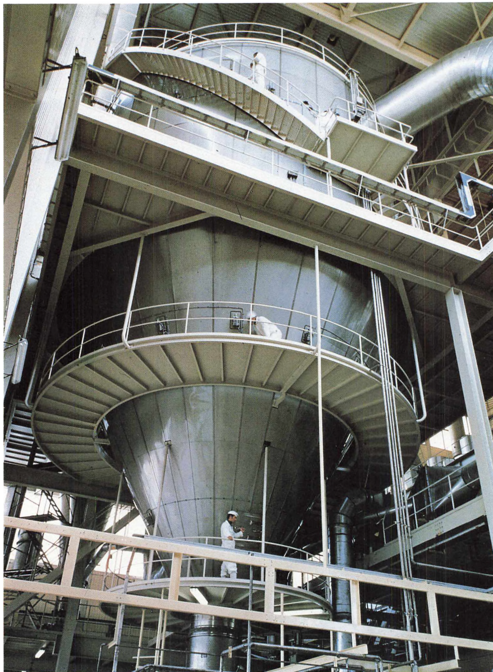
Spraytørringsanlæg til fremstilling af mælkepulver, kapacitet 3–5 tons pulver pr. time.
