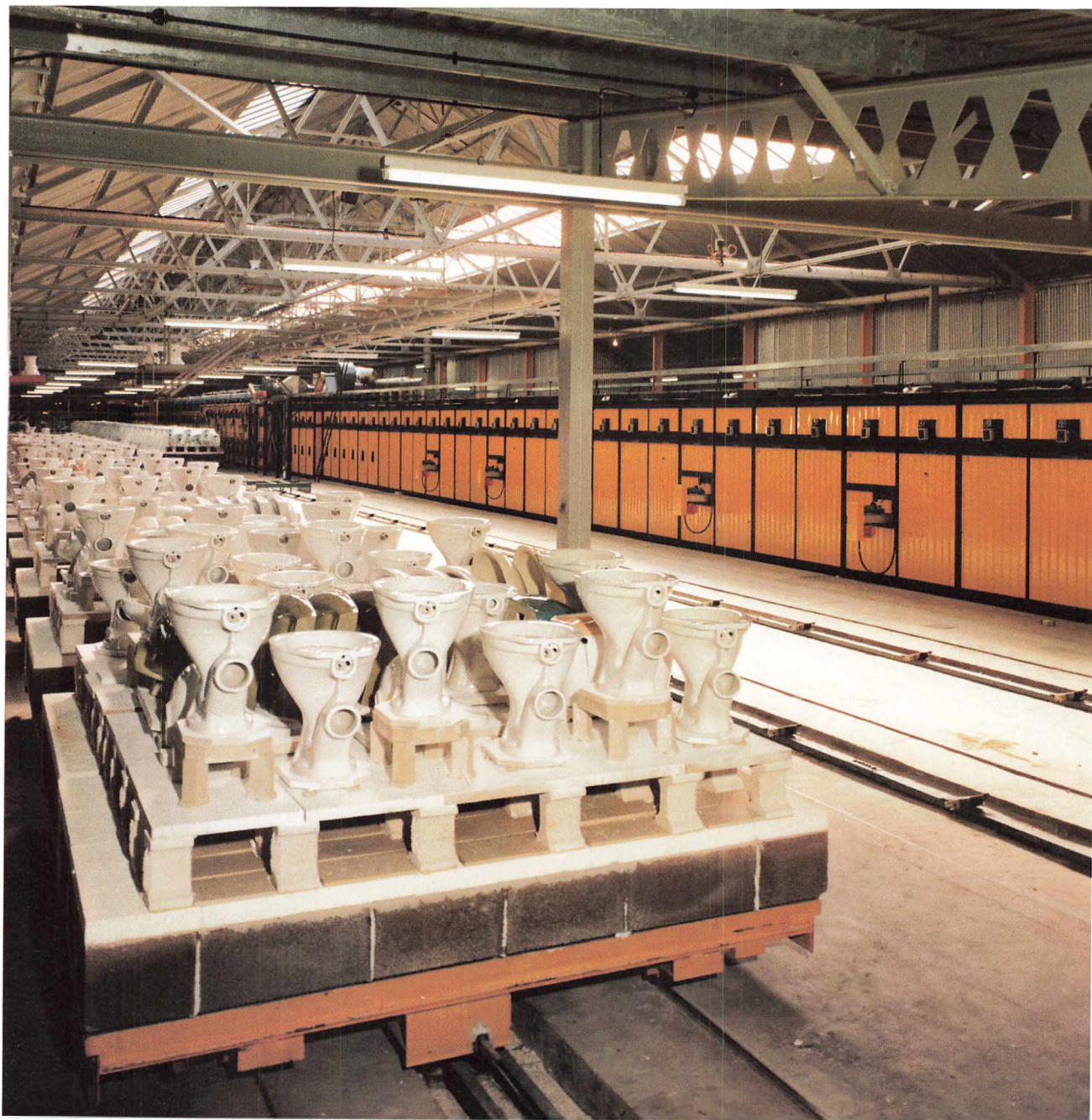
Tunnelovn til brænding af sanitetsporcelæn.
