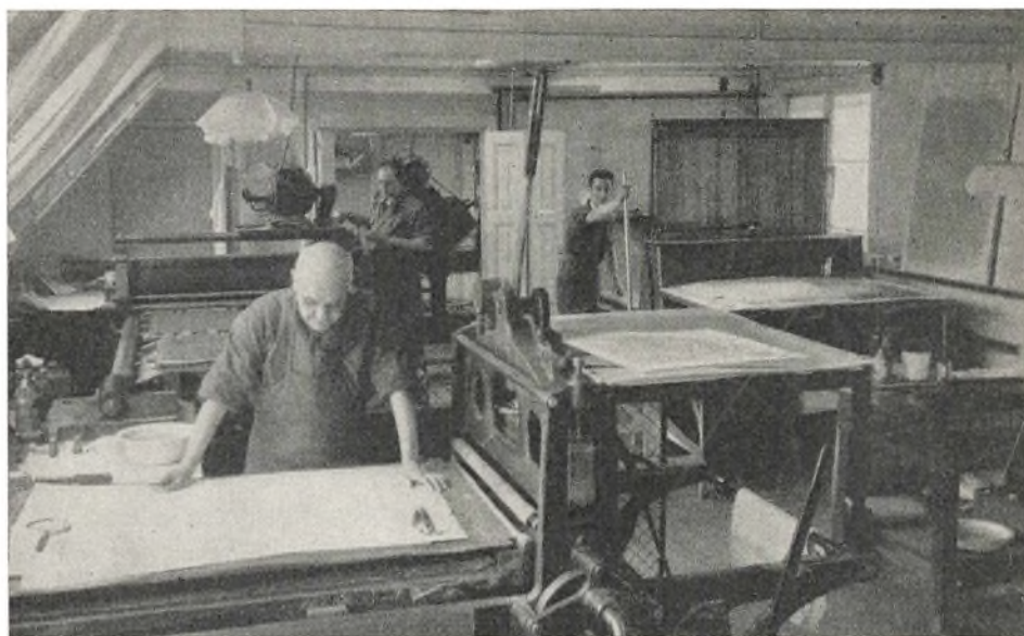
Teknisk Afdeling. Et Hjørne af Overtrykkeriet. Her udføres de forberedende Arbejder ved Fremstillingen af Trykplader til Kortene, f. Eks. Indføring af Over- og Undertekster, Prøvetrykning, Udførelse af Arbejdsplader, der bruges til Oplagstrykning for at spare Originalpladerne.
