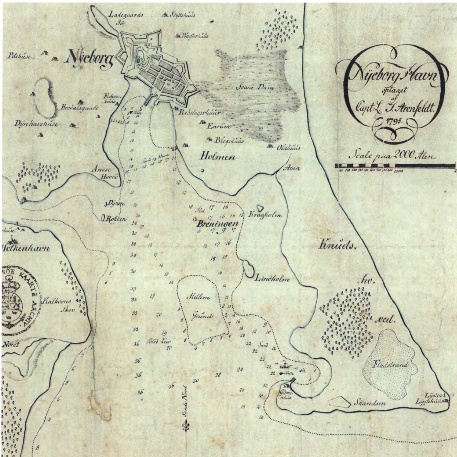
Udsnit i ca. 5:6 af søkort over indsejlingen til Nyborg i 1:20.000, tegnet 1795 af L.J. Arenfeldt. Kortet er i KMS. Det primære i kortet er selve indsejlingen med angivelser af dybde og bund (blød ler, sand og sten), en tønne lige ud for den nordlige skibbro, en anden skibbro findes ved ankerpladsen ved krumodden og »Glimshus« (det lille skib der ligger for anker), en tredje skibbro ved Holmen. For at lette navigationen er desuden angivet sømærker som husene, skovene, skansen og den ophængte lygte ved »Lygtehuset« på spidsen af Knudshoved. Husene er angivet med navn. Navnene kan være ligegyldige for navigationen, det gælder nok også husene nord for Nyborg.
