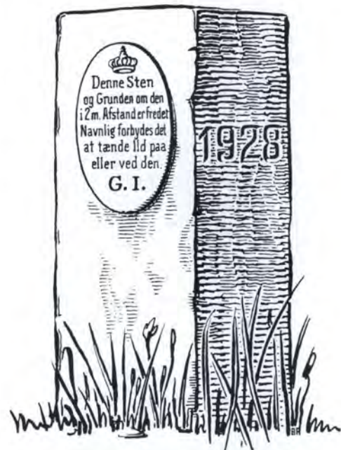
Postament af tilhugget granitsten. Den synlige del rager ca. 1 m op over jordoverfladen og er forsynet med en fredningsplade. Den underjordiske del er nedstøbt i et betonfundament på 1 m 2 . Stationscentret er afmærket ved et hul i en messingbolt, nedfæstet i stenens top.
