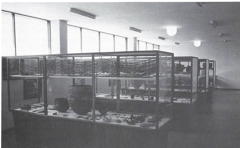
Oldtidssamlingen, som der var udstillet i årene 1959-71. I loftet ses de elektriske strålevarmerør, som udgjorde museets opvarmning indtil 1989. De gav megen støv og kun lidt varme.
