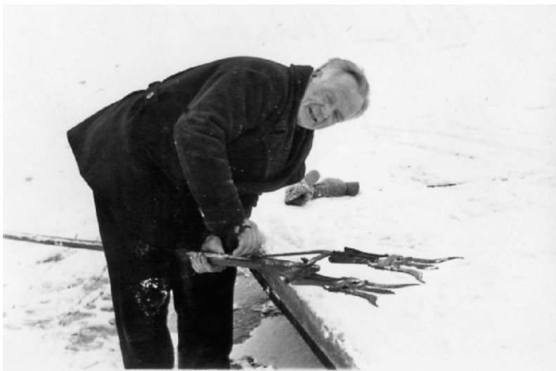
Holger Thisted med ålejern, der er sammensat af to savbystre. (Foto i Viborg Lokalhitoriske Arkiv).
