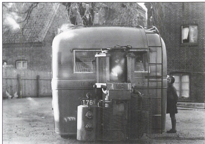
Gasgeneratorer af alle mulige fabrikater blev monteret på alle slags biler - her på bybussen i Skive.
