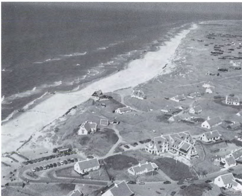
Luffoto ca. 1995 af Gl. Skagen, der giver et godt indtryk af, at forstranden er stærkt øget siden 1949 som følge af udlagte høfder.
