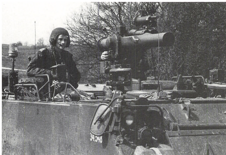
Panserværnsraklet monteret på pansret mandskabsvogn.
