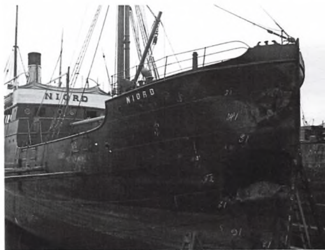
Fragtdamperen »Njord« på bedding for at få repareret en skade. »Njord« blev leveret til sit rederi i 1894.
