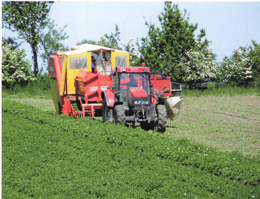
I slutningen af sæsonen, hvor kartoflerne ikke er så sårbare, kan maskinen optage fem tons i timen.
