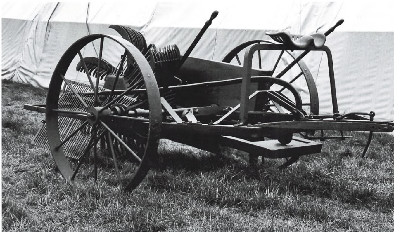
Kartoffeloptager. Meget svær maskine med kraftige skovlblade, som graver kartoflerne op og kaster dem ud til højre i kørselsretningen. Maskinen har været brugt på Sjælland. Dansk Landbrugsmuseum nr. 001.021.
