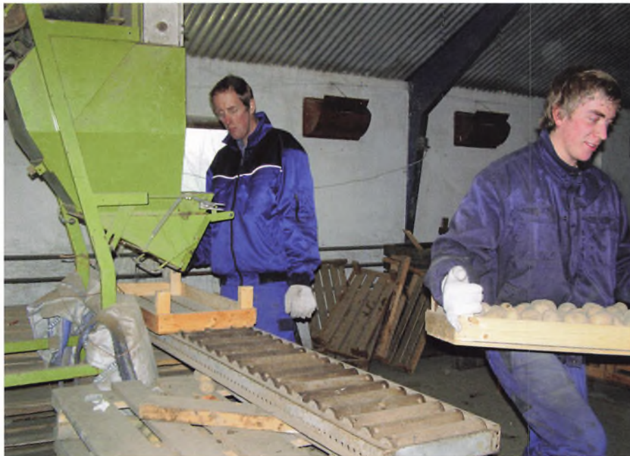
Spirekasserne fyldes maskinelt. Hvad enten kartoflerne er store eller små sørger maskinen for at lægge dem i cirka 1½ lag i spirekassen.
