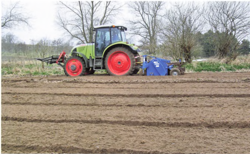
Kartoffellæggeren på vej over den velforberejede mark. Maskinen efterlader to jordkamme med nylagte kartoffer.
