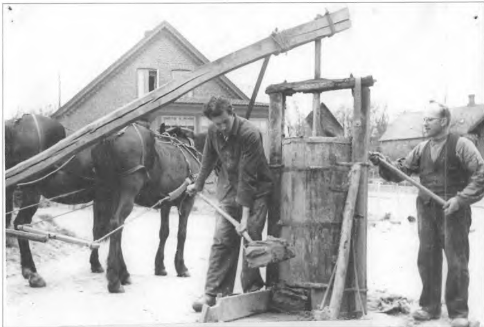
Den gamle æltemaskine med hestegang var endnu i brug i 1950. Knud Jensen læsser på, og Laurids Jensen tager fra. Ælteren står i dag ved museet på Silkeborg Hovedgård i noget medtaget tilstand. (Foto: Rudolph Iversen. Udlånt af Silkeborg Arkiv).
