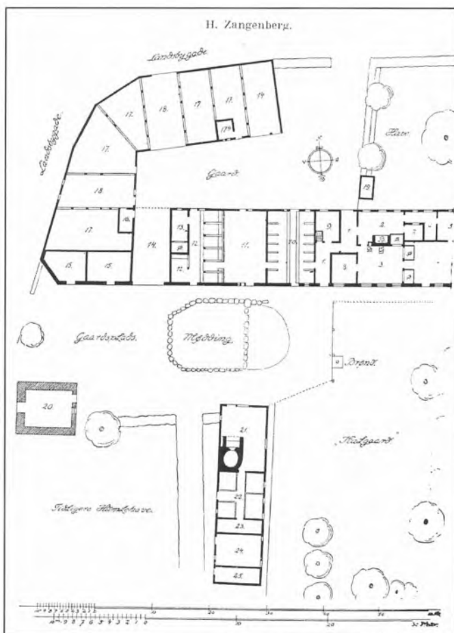
Grundplan over Jollmanns Gård udført af Halvor Zangenberg og bragt i Sønderjyske Aarbøger 1928.
