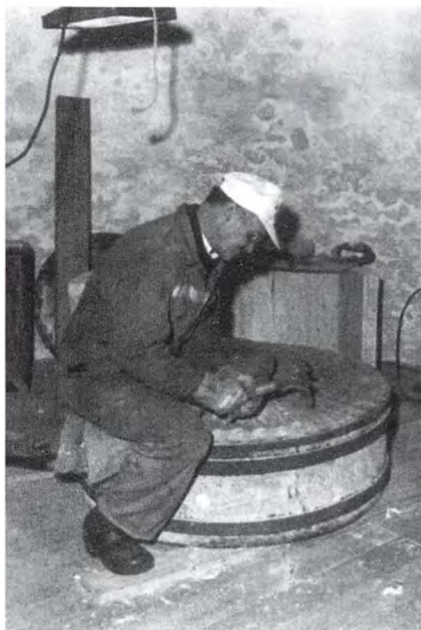
Møller Carl Åge Busk, Fannerup, skærper (bilder) den nederste møllesten (liggeren) i en af kværnene i Gylling mølle. Arbejdet tog 14 timer. (Foto udlånt af Lokalhistorisk Arkiv for Gylling og Omegn).
