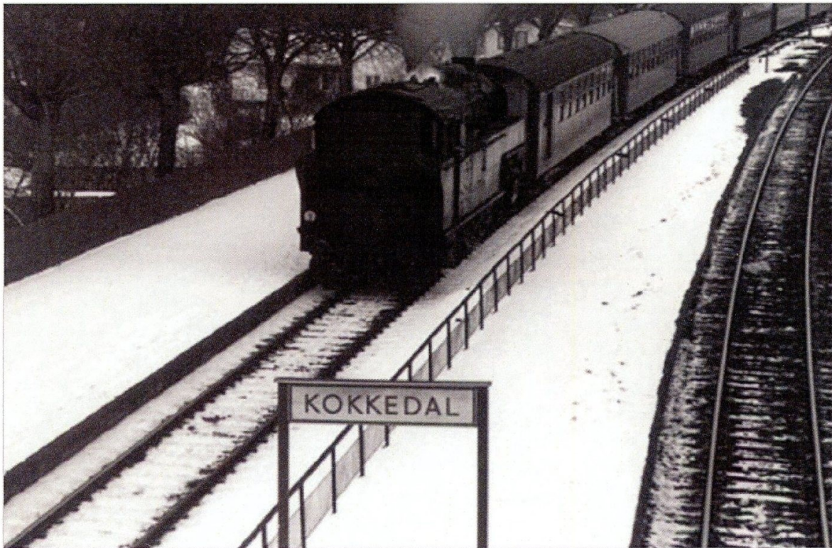
S-lokomotiv. Det kunne trække fra begge ender, fot. Helge Pedersen Hørsholm Egnsmuseum
