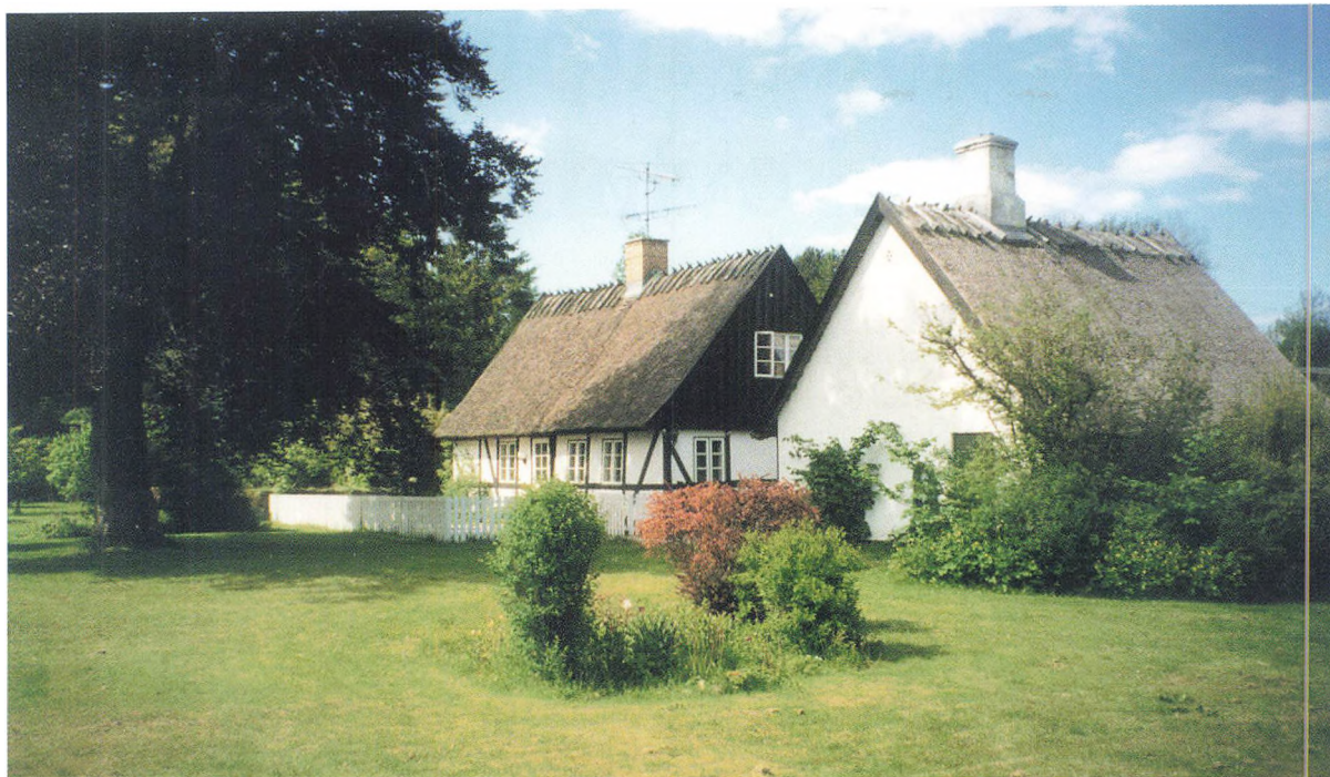
Lokkeruphus set fra sydøst i juni 1997. Hovedhuset har - noget atypisk for nordsjællandske huse - fået frilagt bindingsværket. Den nordsjællandske byggeskik er overkalket bindingsværk, således som det ses på de ældste fotos
