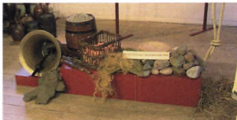
Støbningen af en klokke kræver voks, sand, æg, hamp, sten og naturligvis kobber og tin.
