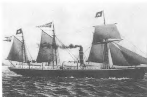
s/s Nordstjernen; ca. 60 meter lang, ca. 8 meter bred, 636 tons, 120 hk dampmaskine, bygget 1855 hos Caird & Co., Greenock, Clyde (Glasgow), Storbritannien til rederiet Bergenske, Bergen, Norge (Lloyds register 1864). I 1864 sejlede Nordstjernen på ruten Bergen/Hamborg som passager/turistskib. I 1881 forliste skibet ud for den norske kyst.
