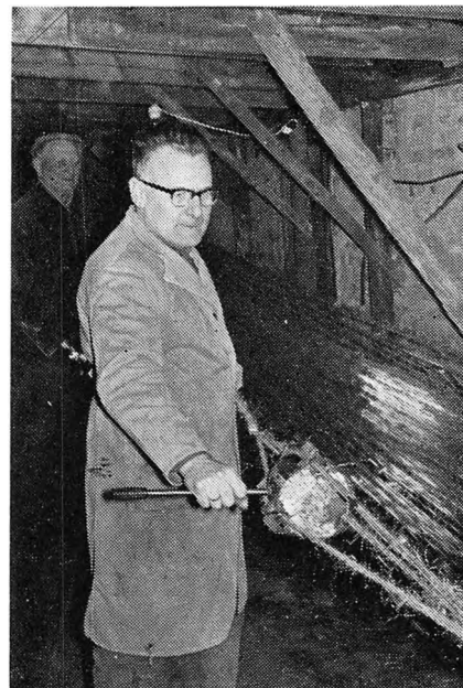
Afdøde H.P. Sahls interesse for rebslageriet var direkte årsag til, at rebslageriet stadig drives i Skjern. Her er han fotograferet under rebslagningen med det redskab, som kaldes »toppen«. Bag ham står en af de mange hjælpere gennem årene, Holger Starcke Jensen.
