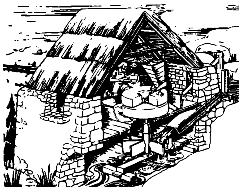
Horisontal vandmølle. (Efter T.S. Reynold, 1983)
