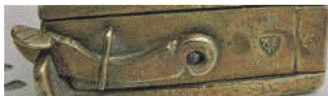
Agterenden af strygejern med låsemekanisme og gørtlerens stempel MS.
