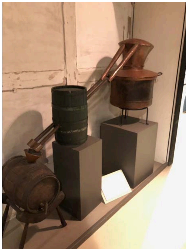
Brændevinsudstyr med kedel, hat og piber. Her set på Det Grønne Museum, Gl. Estrup.
