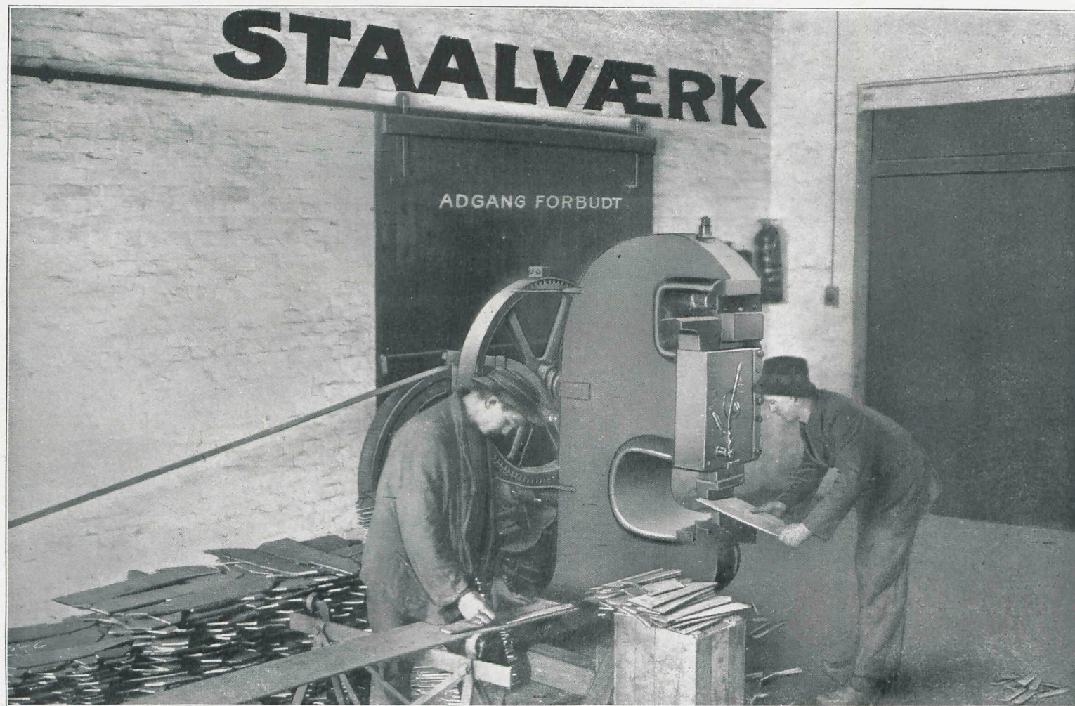
En af de tre store Klippe- og Løkkemaskiner i Færd med Udklipning af Original •Fragde•-Staal
