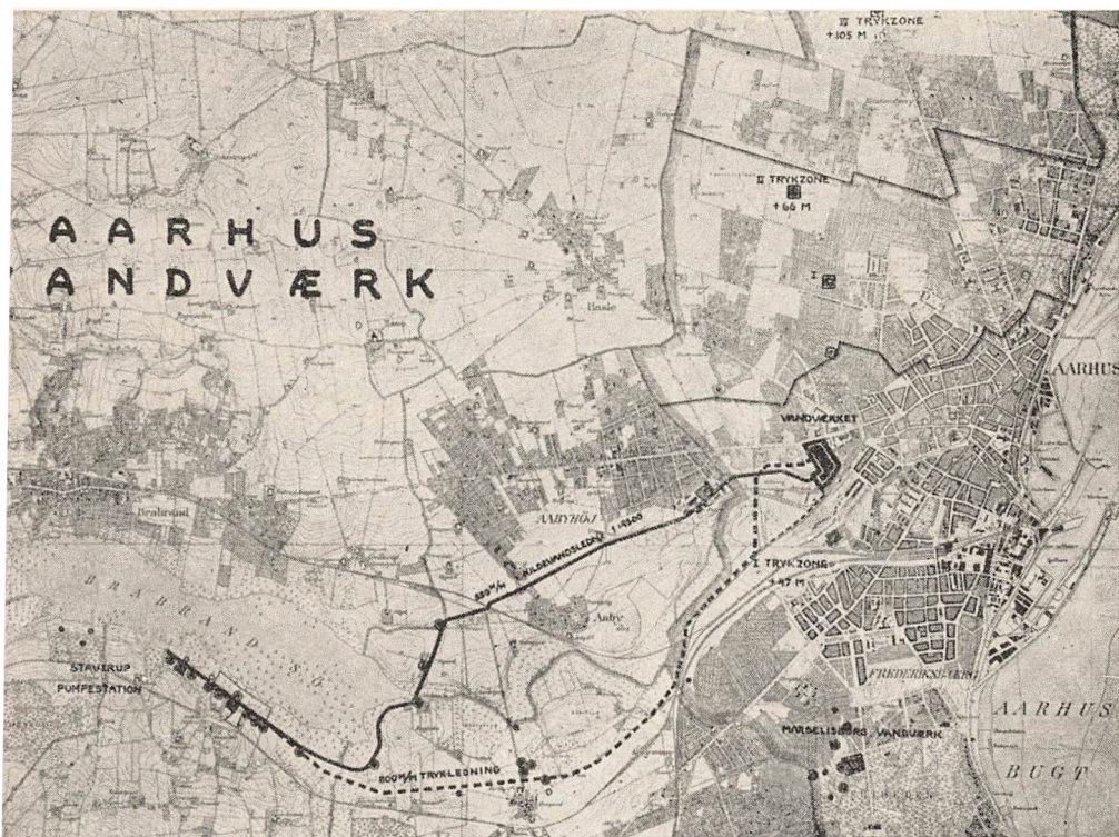
— Gamle Kildevandsledning. - - - - 700 mm Trykledning.
